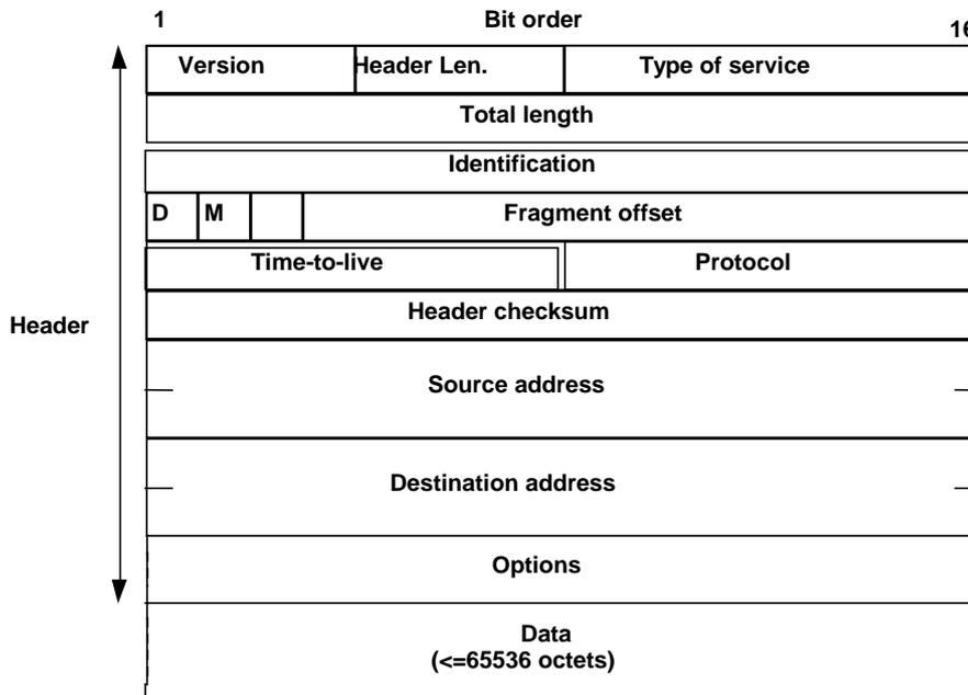
**FIGURE 7-3. IP PACKET HEADER**
