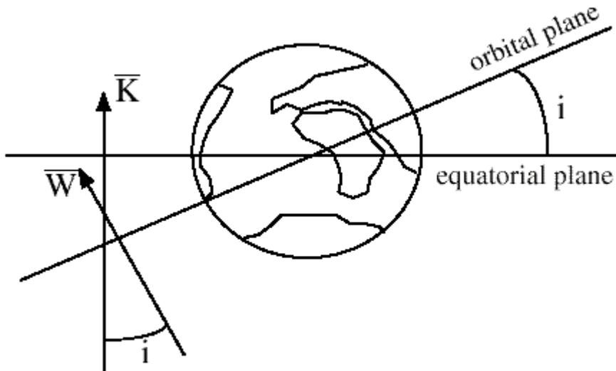
**FIGURE 4-2 INCLINATION OF ORBIT**
