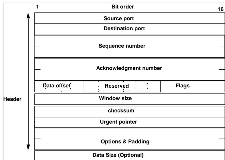
**FIGURE 7-1. TCP HEADER**
