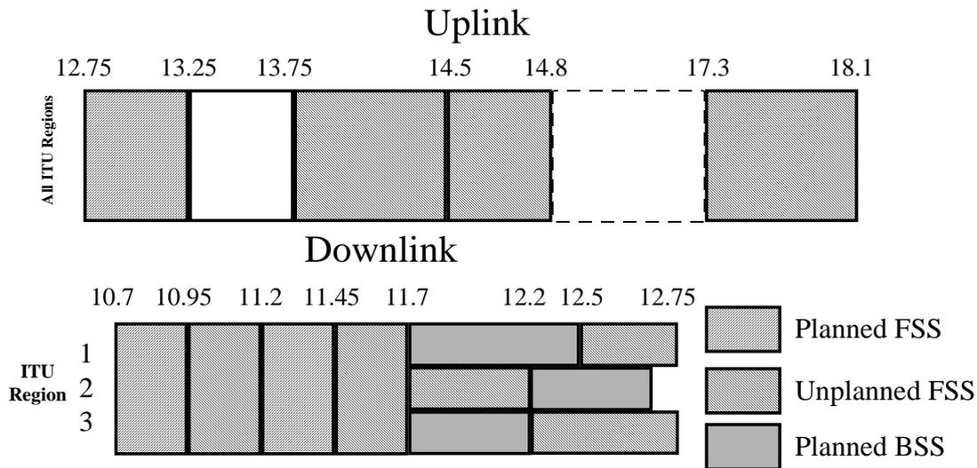
FIGURE 4-28 SYSTEM ALLOCATIONS OF THE PROPOSED SKYBRIDGE FREQUENCY BANDS
