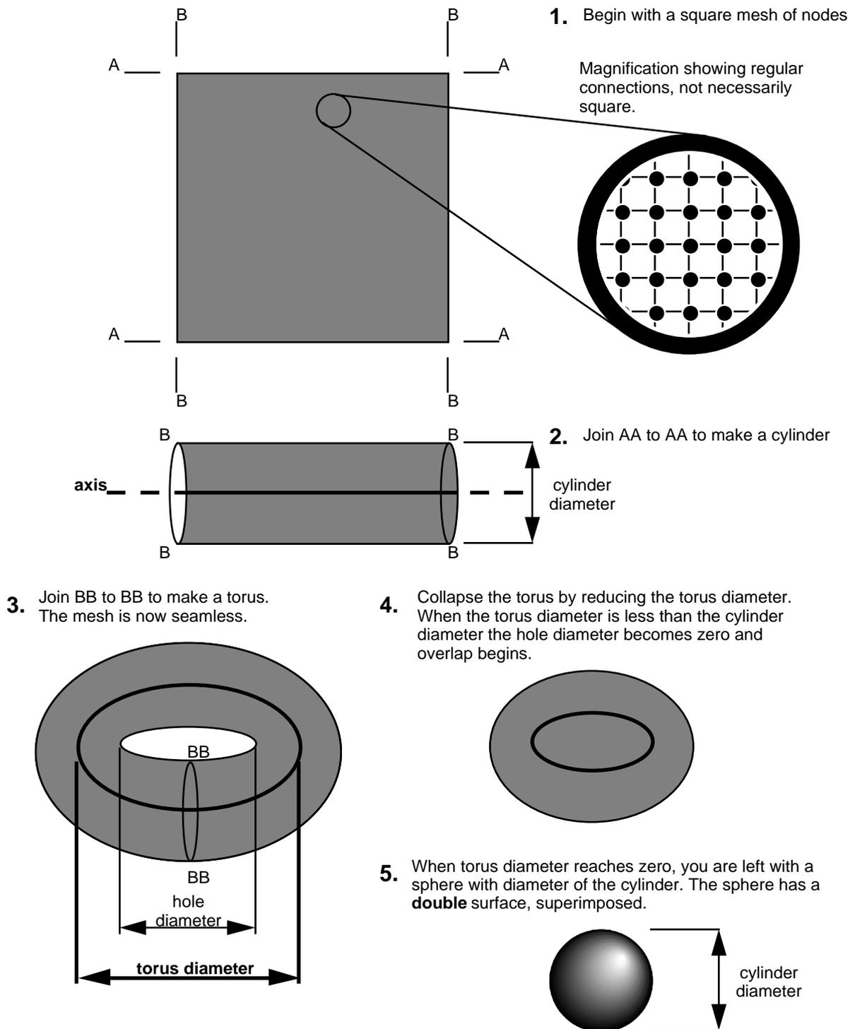
**FIGURE 4-14 HOW A TOROIDAL MESH MAPS INTO THE EARTH**
