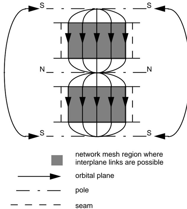
**FIGURE 4-11 FLATTENING THE STAR NETWORK**
